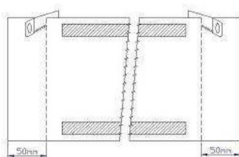
L'acciaio e il ferro sono completamente rivestiti in plastica. Come risultato l'acciaio in questo modo non subisce più la corrosione. Da entrambe le estremità possono essere segati via 5 cm.
